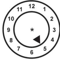
図 6.0.B 製造月を示す例（Example of Indicating the Month of Manufacture）
